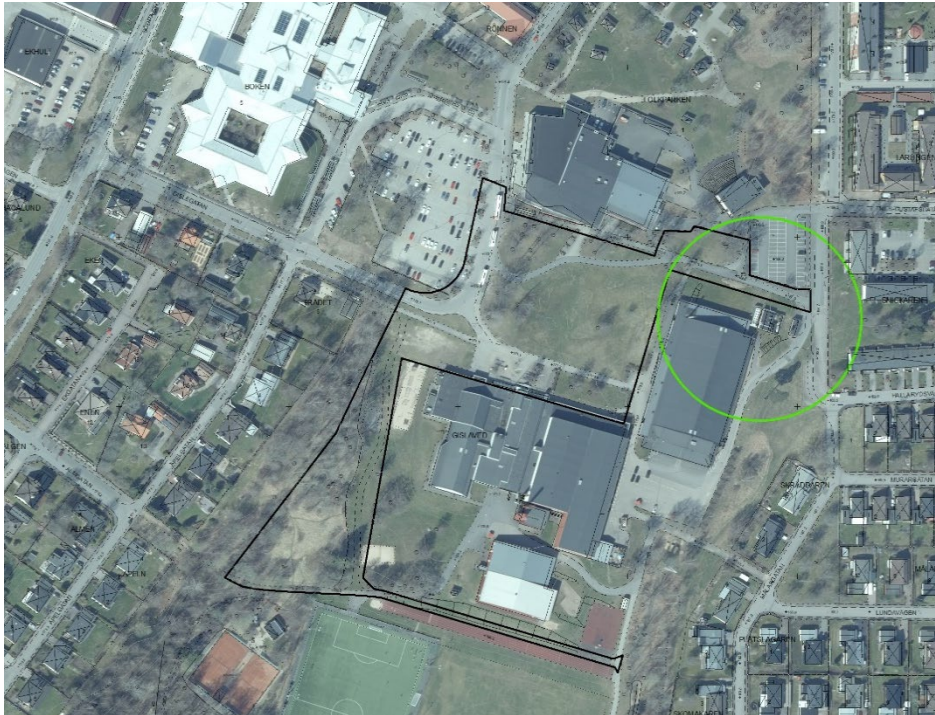
Dimensionerade riskavstånd (60 meter) från befintlig kylanläggning visas med grön cirkel
